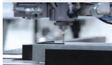
Robot de dépôt de joint bi-composant
