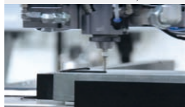
Robot do montażu dwuskładnikowej uszczelki kształtowej
